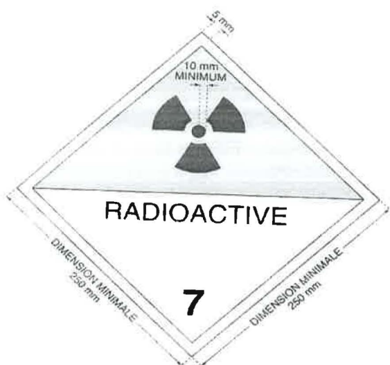
FIG. 5. Placard. Sous réserve des dispositions de l'article 16, les dimensions indiquées sont les dimensions minimales ; en cas d'agrandissement, respecter les proportions. Le chiffre "7" doit avoir une hauteur minimale de 25 mm. Le fond de la moitié supérieure du placard est jaune et le fond de la moitié inférieure blanc, le trèfle et le texte sont noirs. L'emploi du mot "RADIOACTIVE" dans la moitié inférieure est facultatif, de sorte que cet espace peut être utilisé pour apposer le numéro ONU relatif à l'envoi.
