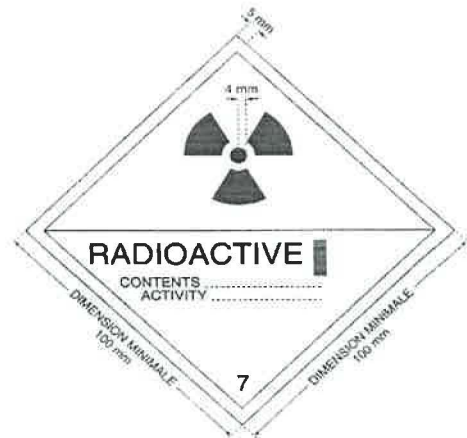
FIG. 2. Étiquette de la catégorie I-BLANCHE. Le fond de l'étiquette est blanc, le trèfle et le texte sont noirs, et le numéro de la catégorie en chiffres romains (une barre verticale) est rouge.
