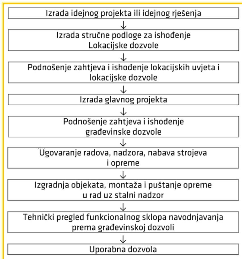
Slika 5.2.2.2.2.3.1. Shema postupka izrade dokumentacije sustava za navodnjavanje
