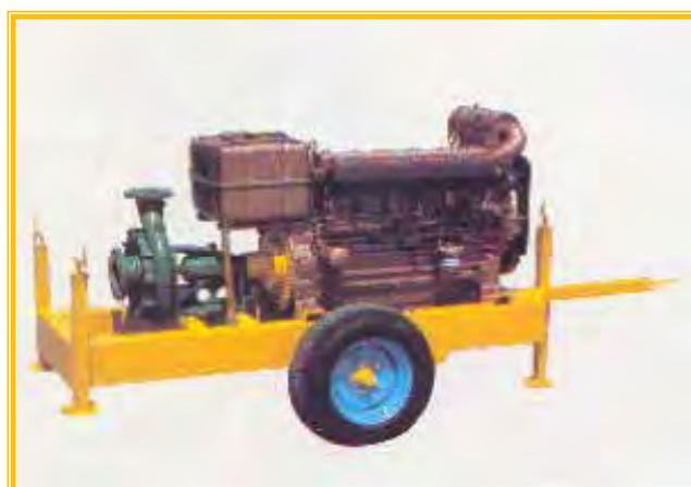
**Slika 4.3.4. Motorna crpka Caprari, MEC-A 4/100A s diesel motorom (usisavanje do 7m)**
