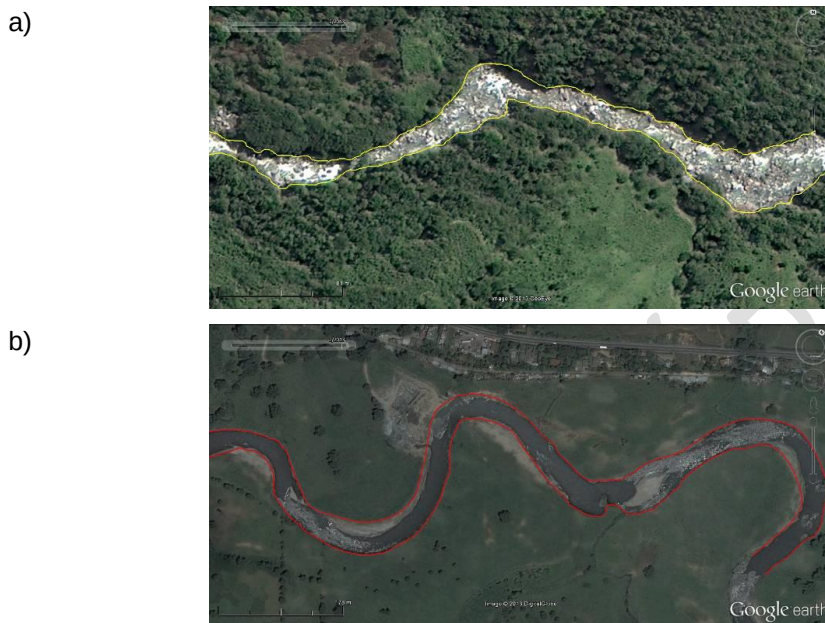
Figura 5-2. Esquematzación de la delimitación del ancho de cauce permanente a partir de Imágenes de Satélite. a) Sistema de alta pendiente (>2.5 %). (b) Sistema de planicie (<2.5 %). Fuente: Google Earth.
