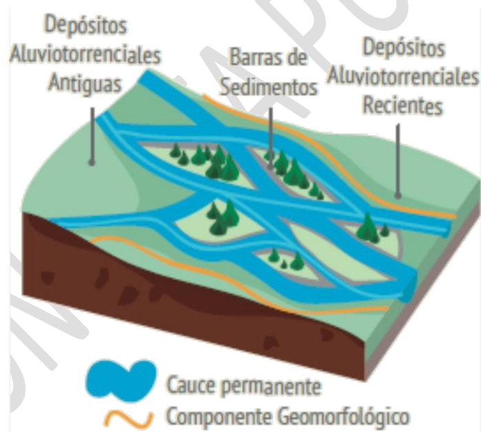
Figura 6-10. Componente geomorfológico de las rondas hídricas en corrientes anastomosadas en llanuras.
