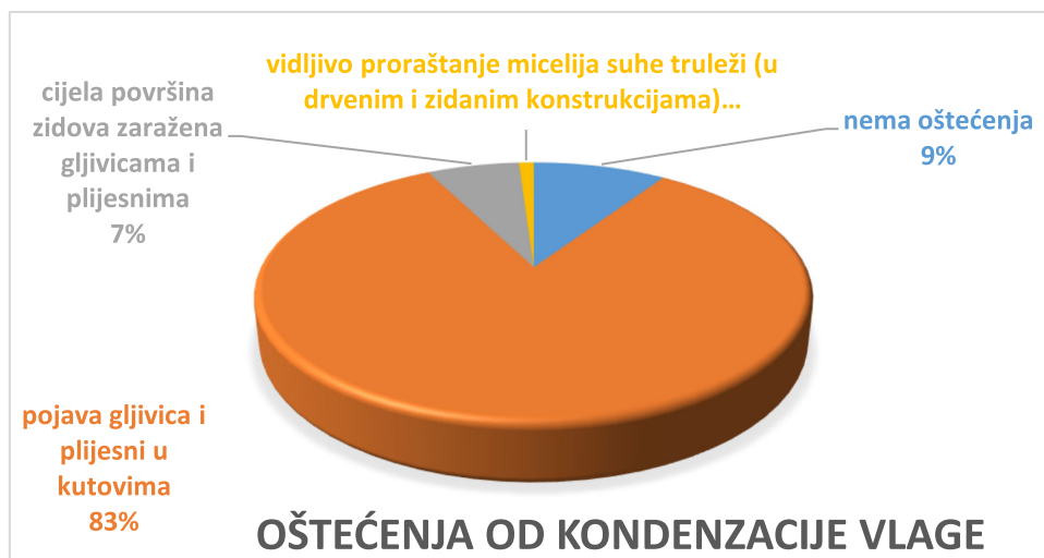
Slika 4-8. Raspodjela zgrada prema oštećenjima od kondenzacija vlage
