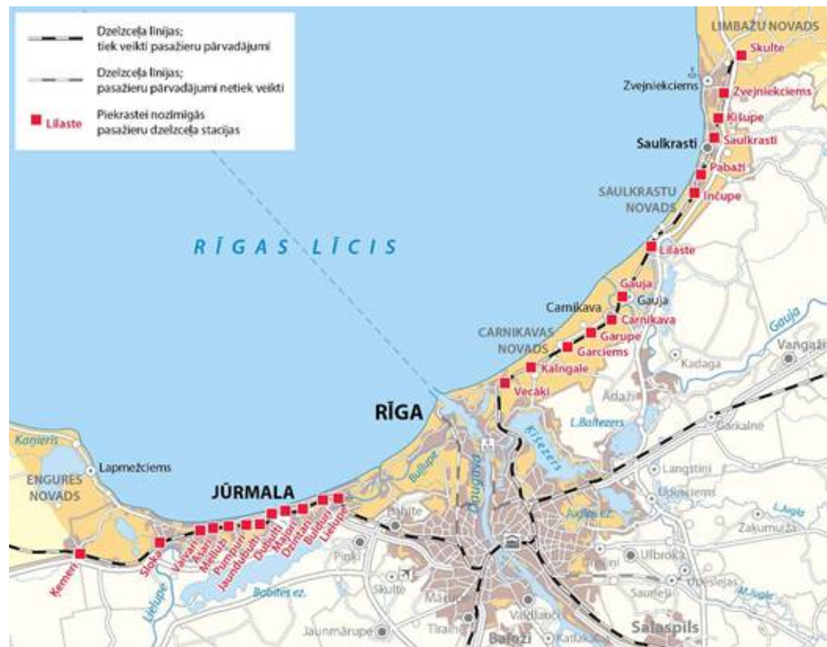
2.6.attēls. Pierīgas dzelzceļa infrastruktūras tīkla principālā shēma 7
