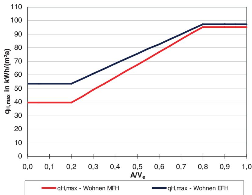
Abbildung 2 - Anforderungen für den spezifischen Heizwärmebedarf
