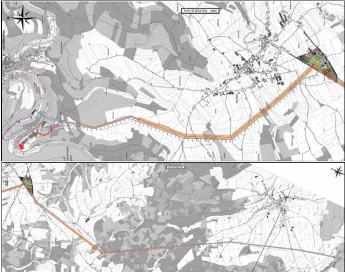
Annexe 2 : Tracé de la nouvelle conduite de refoulement vers la nouvelle station de traitement à Eschdorf (en haut) et tracé de la nouvelle conduite d'adduction de la nouvelle station de traitement à Eschdorf vers la chambre à vannes Schankengraecht (en bas)
