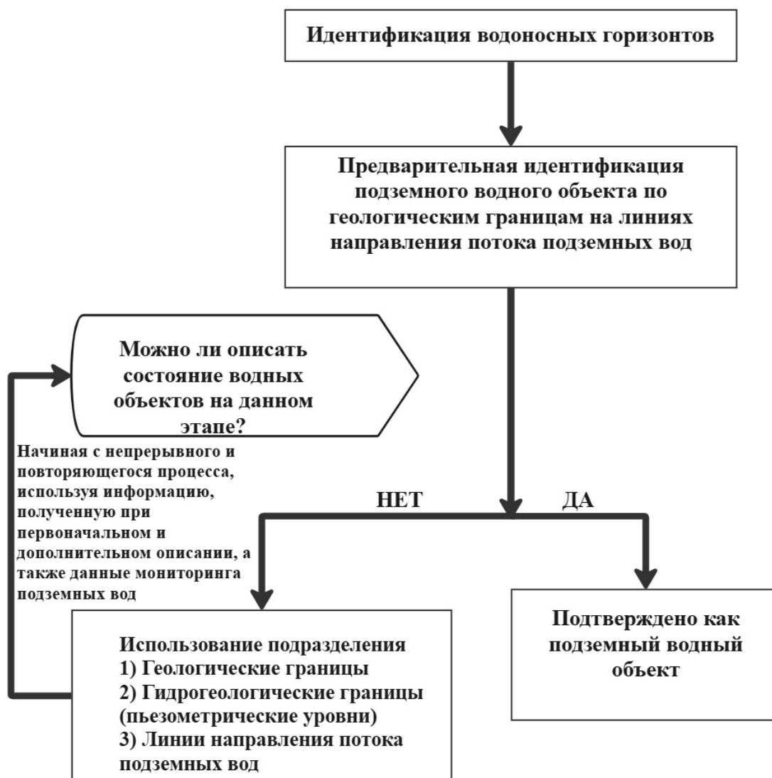
Рисунок 1. Последовательный процесс идентификации подземных водных объектов
