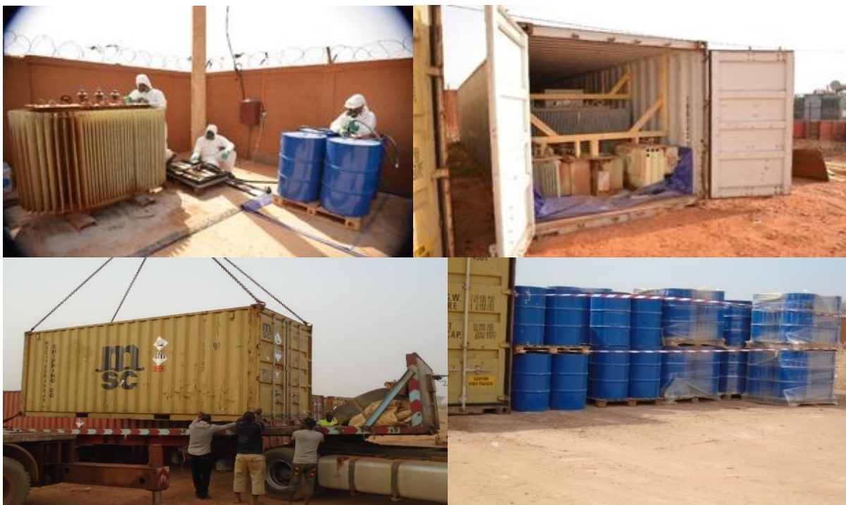
Photo 5: Dispositif d'expédition de PCB et déchets à PCB, Coordination Nationale du Projet PCB, 2016
