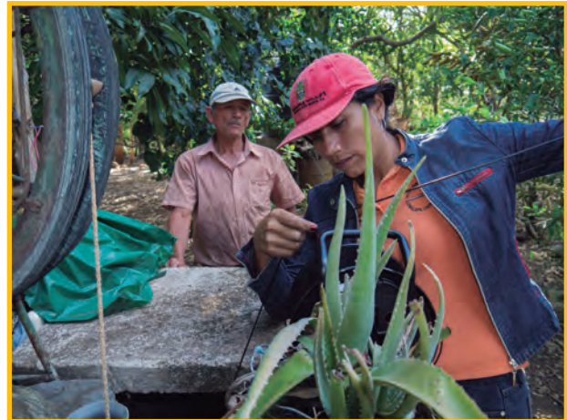
Foto 15: Técnica municipal de Comalapa midiendo nivel de agua subterránea en pozo excavado
