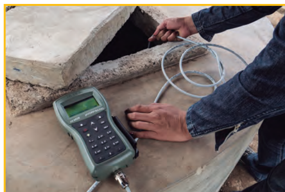
Foto 18: Lectura directa de equipo multiparámetro utilizado para medición cualitativa in situ
