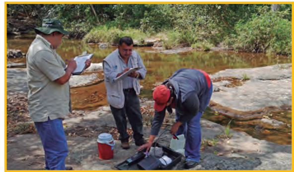
Foto 8: Levantamiento de muestras de agua superficial para análisis químico.
