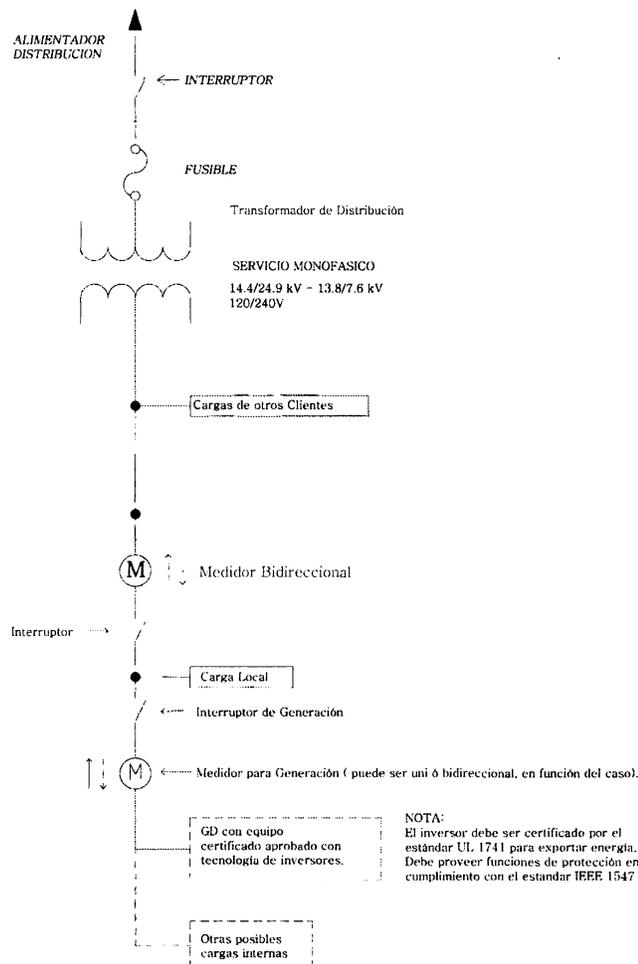
**2. Diagrama Unifilar Ilustrativo de Protección para GD Rotacionales Sistema de Distribución Secundaria.**
