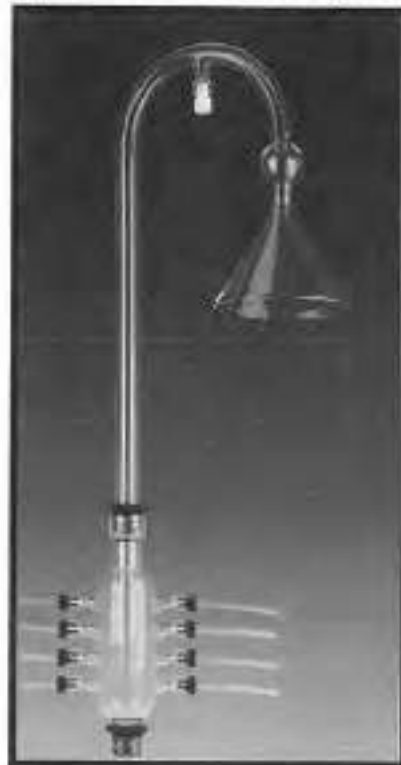
Figura 7. Ejemplo de manifold para toma de muestras de gases
