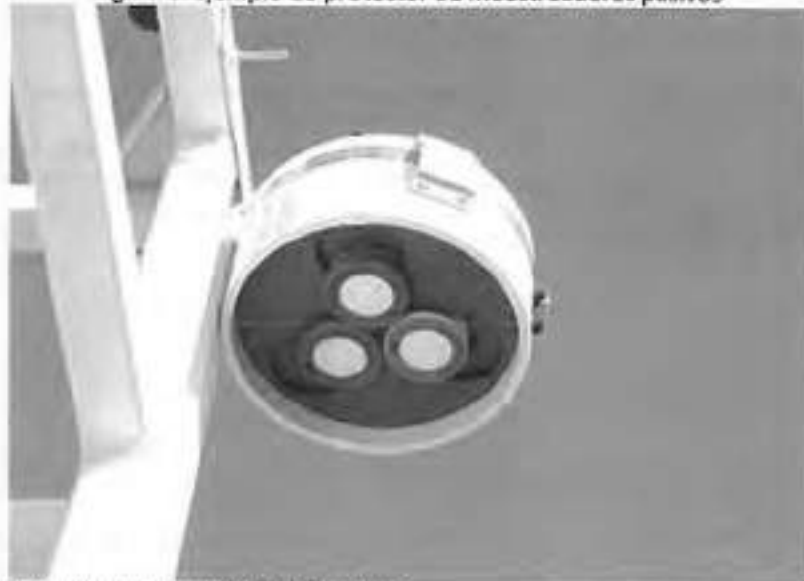
Figura 6. Ejemplo de protector de muestreadores pasivos
