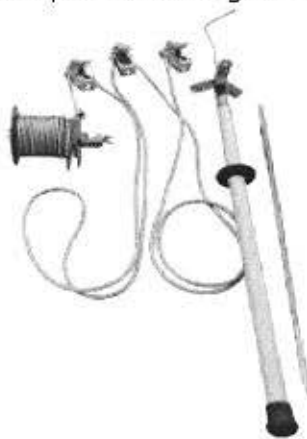
Figura N° 14: Sistema para la puesta a tierra para transformadores
