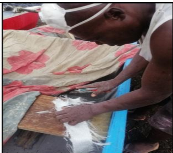
Reparação com fibra de vidro
