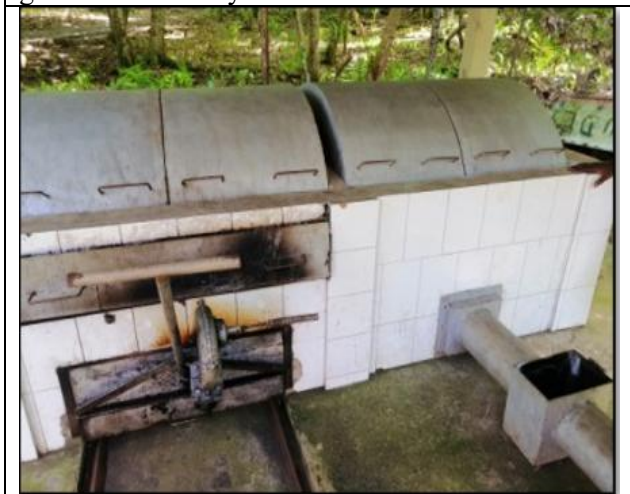
Figura 25. Ilustrações relativas ao forno de fumagem “FTT Thiaroye” em Messias Alves
