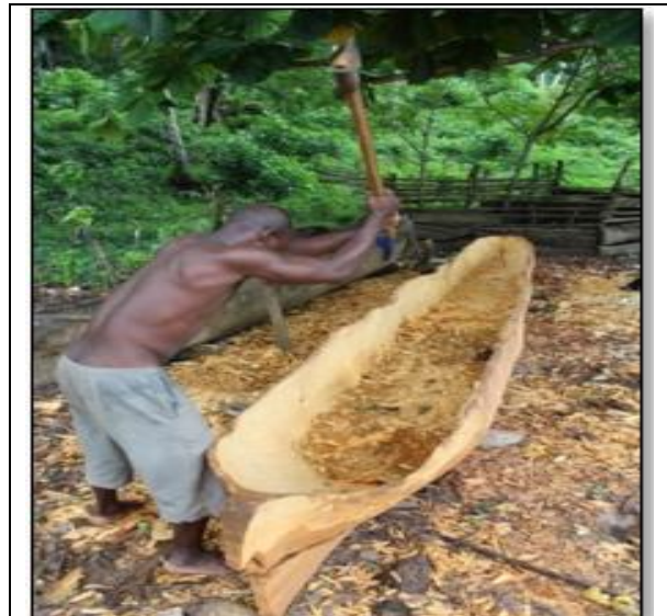
Figura 11. Ilustrações relativas à construção de uma canoa de tronco escavado
