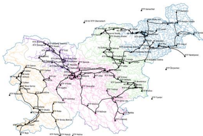
Slika 68: Topologija 110 kV in srednje napetostnih omrežij v Sloveniji
