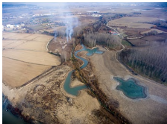
Fotografía 5. Medidas de mejora de las condiciones morfológicas. Eliminación de obras de defensa sin efectos significativos negativos sobre los usos del suelo y demolición de infraestructuras hidráulicas en desuso. Retranqueo de mota de tierra (izq.) y recuperación de la llanura de inundación con canal trenzado (dcha.), en el río Arga.
