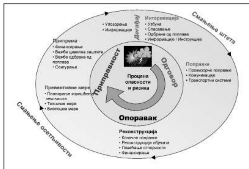
Слика 41. Циклус управљања ризиком од поплава у речном сливу
