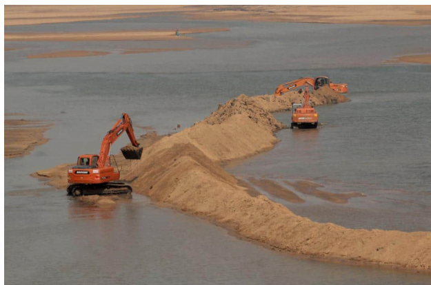
Imagem 5: Imagens mostrando a extração e dragagem de areia a partir de rios ativos ( in-stream mining ) no Rio Kuakhai em Bhubaneswar, Índia (esquerda) e a dragagem de areia na região amazônica, Brasil (direita). Fonte: ecowatch.com e dreamtime.com.
