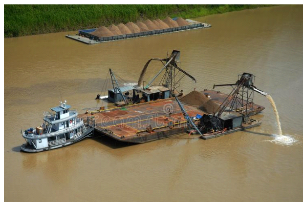
Imagem 5: Imagens mostrando a extração e dragagem de areia a partir de rios ativos ( in-stream mining ) no Rio Kuakhai em Bhubaneswar, Índia (esquerda) e a dragagem de areia na região amazônica, Brasil (direita). Fonte: ecowatch.com e dreamtime.com.
