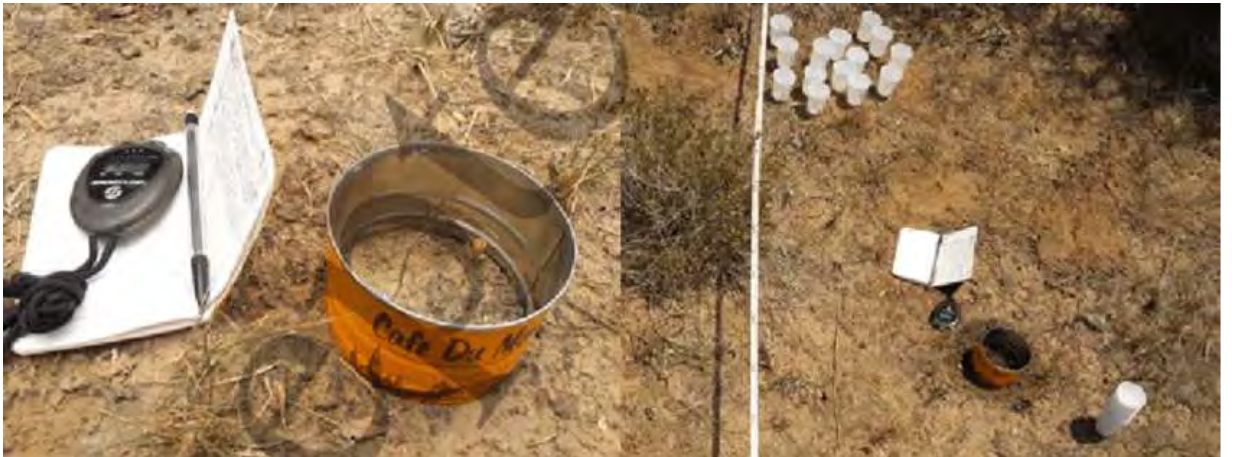
Şekil 16. Su emilim ve tutum göstergesinin izlenmesi için ihtiyaç duyulan metal boru ve diğer ekipmanlara bir örnek.
