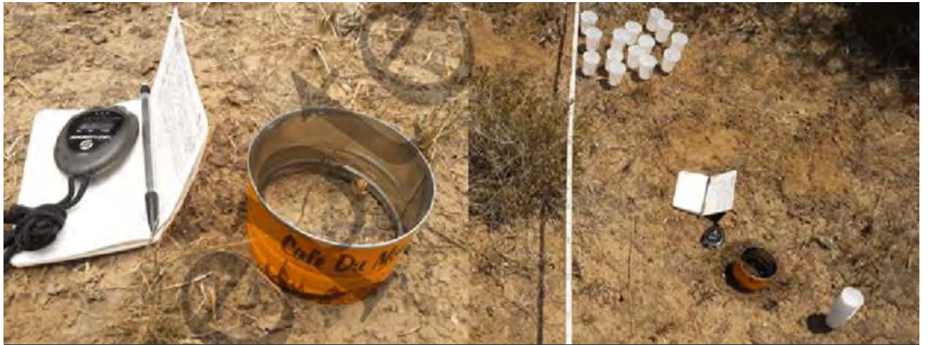
Şekil 28: Su emilim ve tutum göstergesinin izlenmesi için ihtiyaç duyulan metal boru ve diğer ekipmanlara bir örnek (Leite et al., 2020)
