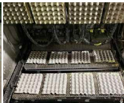
Ilustración 7: Línea de producción de maple de huevos.
