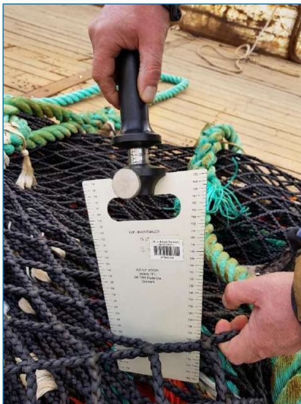
Figura 1: Medición con dinamómetros y galgas UTZON
