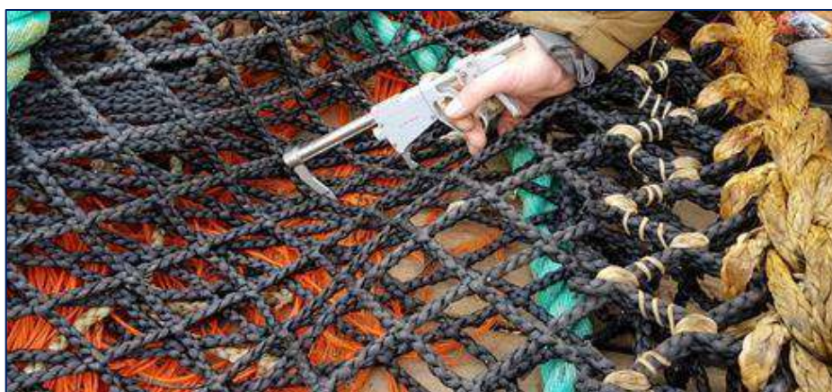
Figura 2: Medición con calibres de tensión tipo CIEM
