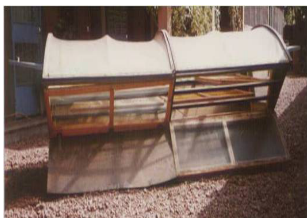
Remplissage de claie d'un séchoir Banco, (Photo CEAS Burkina)
