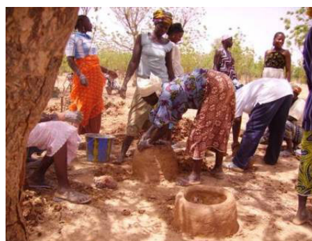
Illustration et réalisation et d'un foyer amélioré 3PA (Illustration, MEE, 2001)
