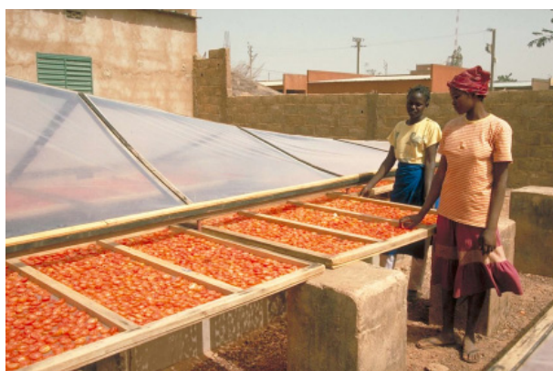
Séchoir solaire tunnel (Source : CEAS Burkina)
