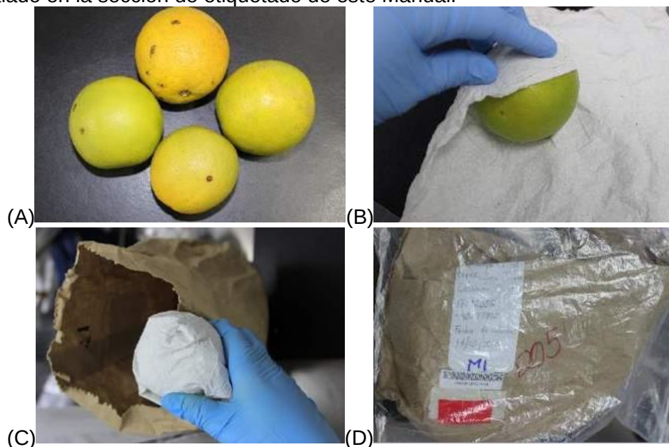
Figura 8. Ejemplo de embalaje: (A) Muestra de tejido vegetal (frutos). (B) Envoltura con papel secante. (C) Colocación de muestra dentro de bolsa de papel. (D) Muestra dentro de bolsa de papel y bolsa de plástico
