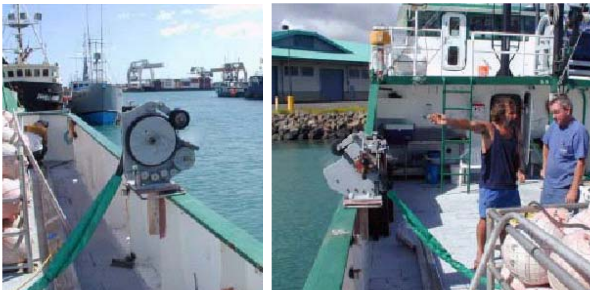
Figura 16: Calador de línea, utilizado en barcos atuneros en Hawai. En la foto, la máquina para calar la línea está ubicada sobre la banda de babor, para calado lateral de la línea (Fuente: SPC Fisheries Newsletter #106 – July/September/2003).
