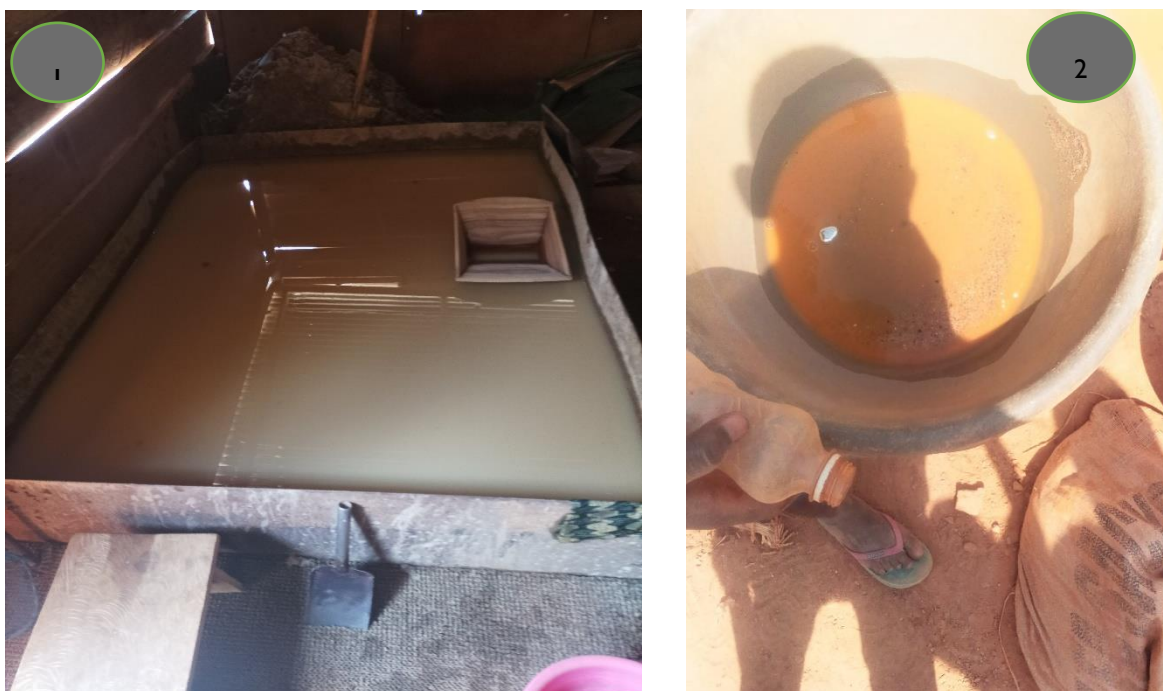
Figure 5: Méthode de traitement par amalgamation au mercure (1) Bac de lavage (2) batée (photo, MINMIDT, 2022)
