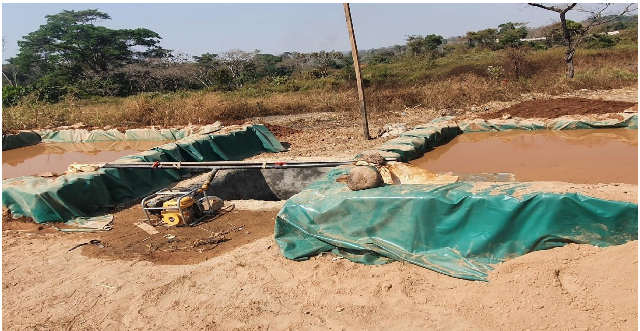
Figure 4 : Méthode de traitement au cyanure à Narkoyo dans la localité de Bétaré-Oya (photo, MINMIDT,2023)
