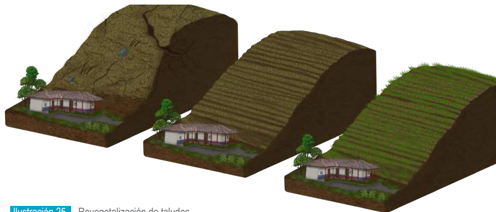
Ilustración 25. Revegetalización de taludes
