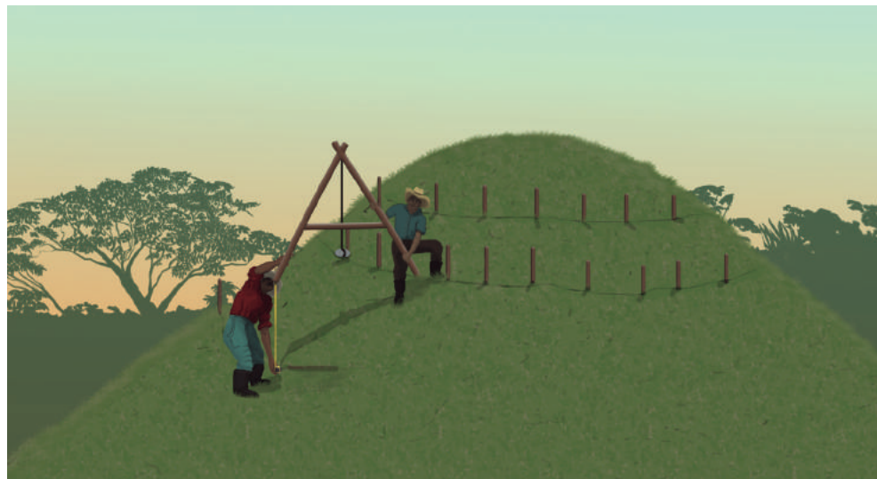
Ilustración 27. Trazado de curvas de nivel con un nivel tipo "A"
