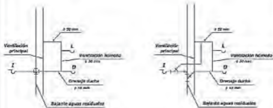
b) VENTILACIÓN HÚMEDA EN PISOS INFERIORES
