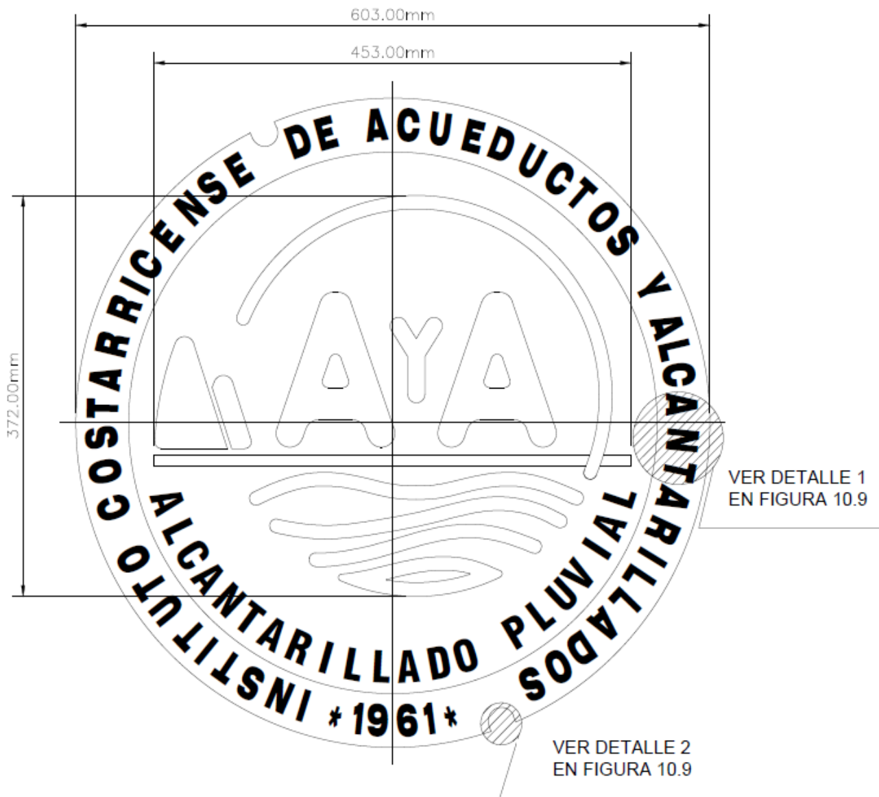
TAPA PARA POZO DE REGISTRO PLUVIAL ESCALA 1:5000
