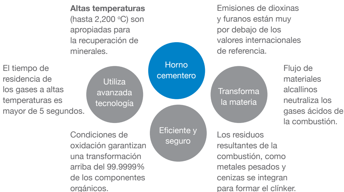
Figura 2. Condiciones de funcionamiento de horno cementero
