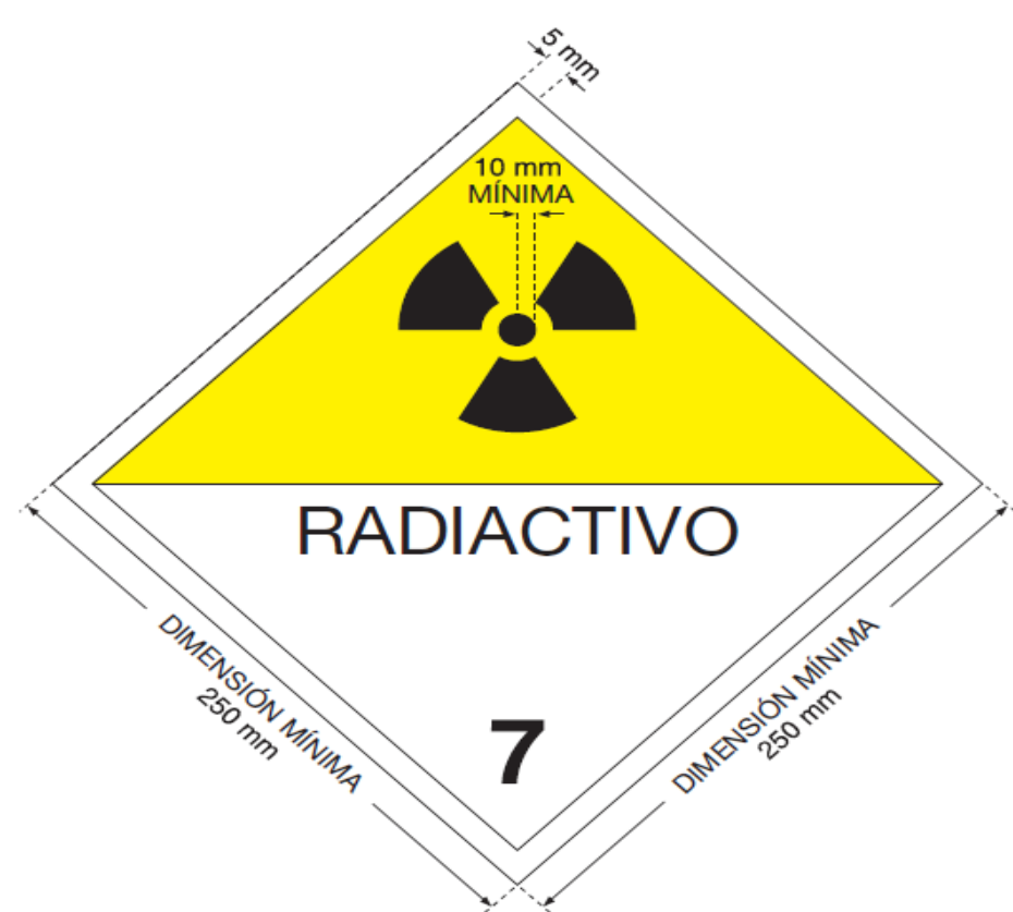
FIG. 6. Letrero. Las dimensiones mínimas deben ser como se muestran. El número “7” no debe medir más de 25 mm de alto. El color de fondo de la mitad superior del letrero debe ser amarillo y el de la mitad inferior blanco; el color del trisector y las letras debe ser negro. El uso de la palabra “RADIOACTIVO” en la mitad inferior es opcional para permitir el uso alterno de este letrero con el número asignado por las Naciones Unidas para la consignación.
