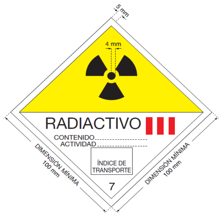
FIG. 4. Categoría III – Etiqueta AMARILLA. El color de fondo de la mitad superior de la etiqueta debe ser amarillo y la mitad inferior blanca; el color del trisector y las letras debe ser negro, y el color de las barras de categoría debe ser rojo.
