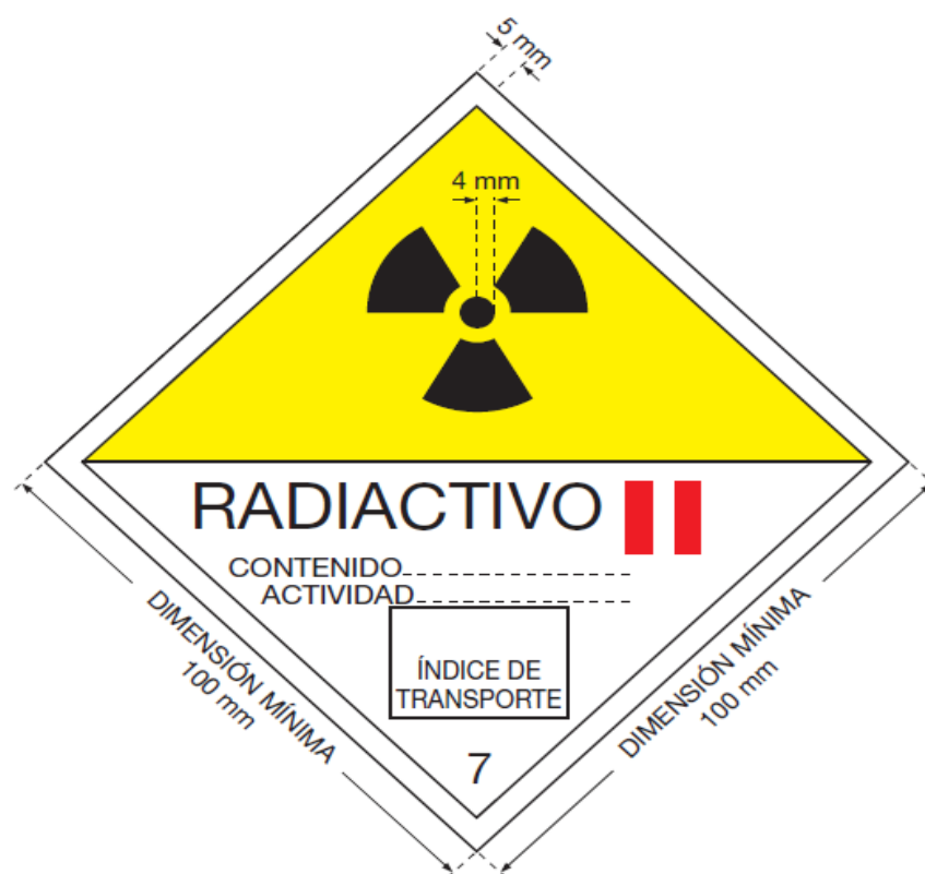
FIG. 3. Categoría II – Etiqueta AMARILLA . El color de fondo de la mitad superior de la etiqueta debe ser amarillo y la mitad inferior blanca; el color del trisector debe ser negro, y el color de las barras de categoría debe ser rojo.
