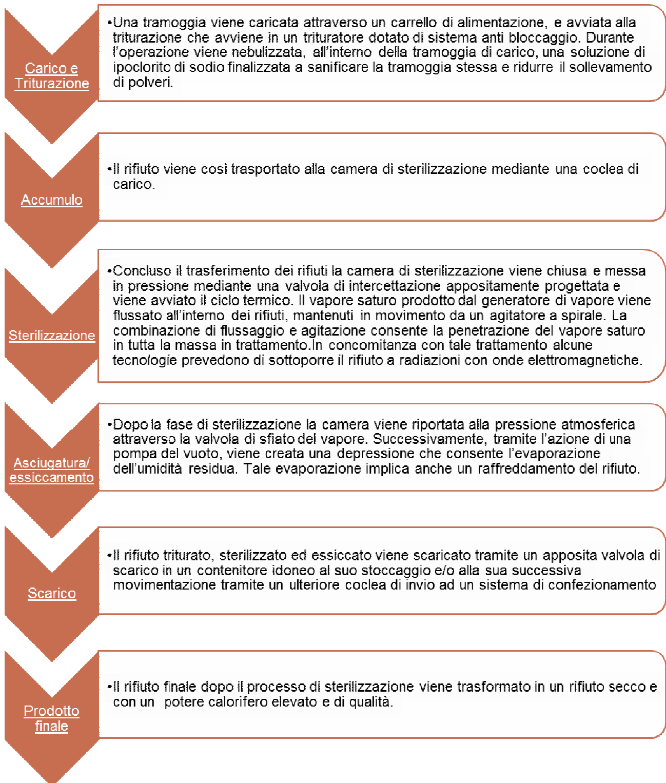
Fig. 5.6 Ciclo di trattamento di una sterilizzazione a vapore in pressione.
