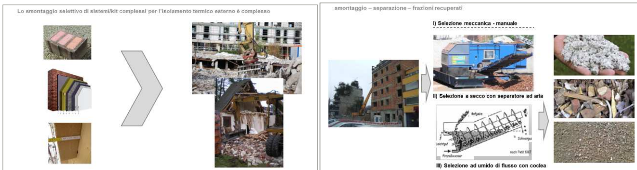
Abb. 4.6 Phasen des Trennprozesses leichter Materialien von B&A-Abfällen (Quelle: Syneco GmbH).
