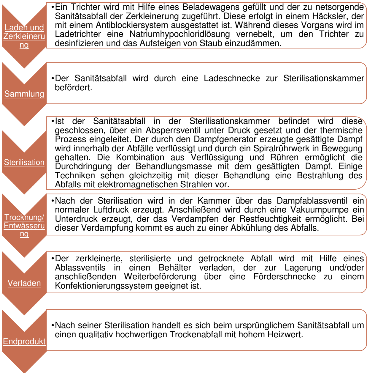
Abb. 5.6 Verfahrenszyklus einer Dampfdruck – Sterilisation.
