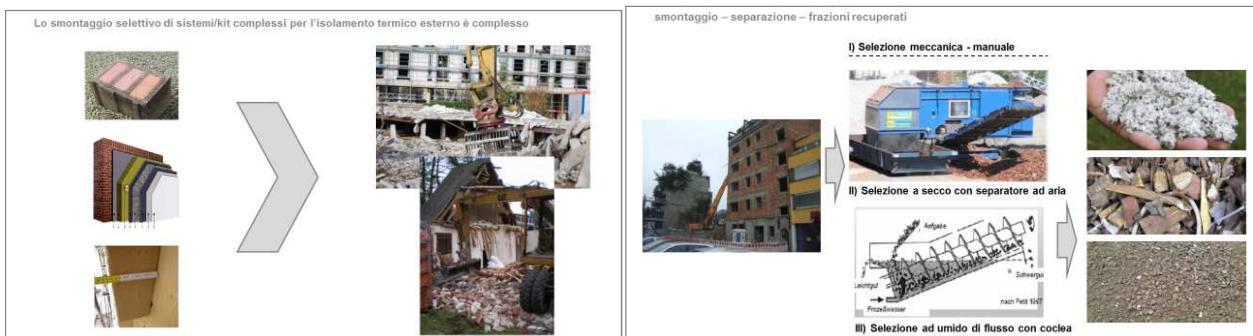
Fig. 4.6 fasi di processo di separazione di materiali leggeri da rifiuti C&D (Fonte: Syneco srl)
