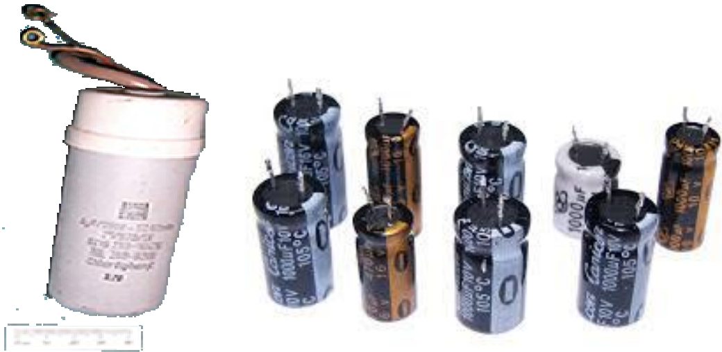
Figure 20 : Exemple de condensateurs contenant des PCBs, pour ses propriétés diélectriques
