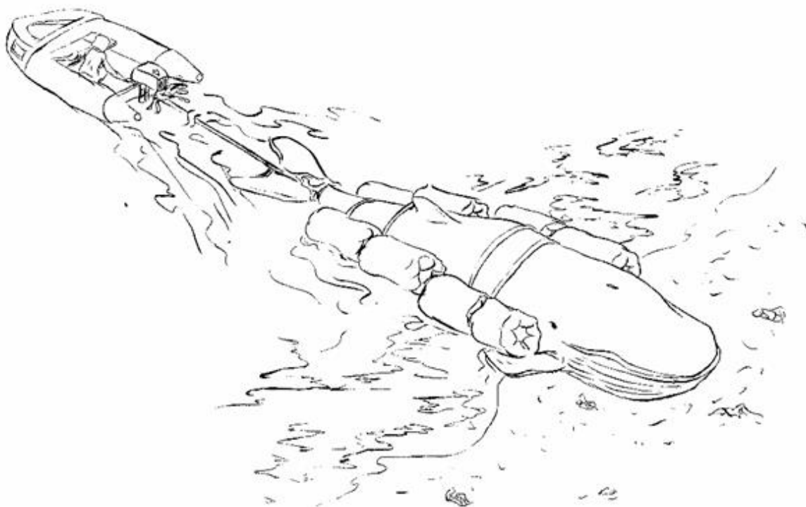
Figura 6. Método para remolcar una ballena varada.
