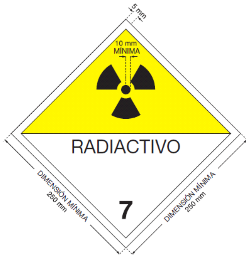
Figura A.6 Rotulado. Las dimensiones de este modelo son las mínimas; cuando se utilicen rótulos de distintas dimensiones se guardarán las mismas proporciones que en el modelo. El número "7" tendrá una altura no inferior a 25 mm. El color de fondo de la mitad superior del rótulo será amarillo y el de la mitad inferior blanco, el trébol y los caracteres y líneas impresos serán negros. El empleo del término "RADIOACTIVO" en la mitad inferior es facultativo, con el fin de permitir también la utilización de este rótulo para indicar el número apropiado de las Naciones Unidas correspondientes a la remesa.
