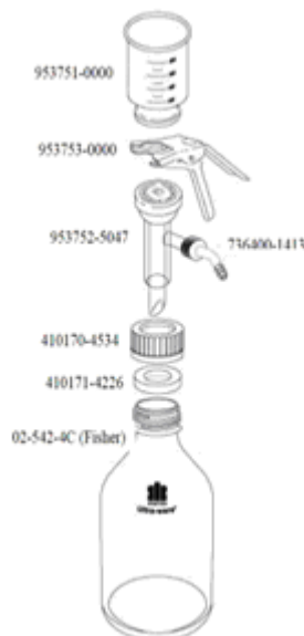
Fig. B.1.2-1 Partes del dispositivo de filtración
