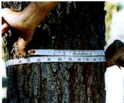
**Figura 14.** Posición correcta de la cinta diamétrica para medición del DAP.
