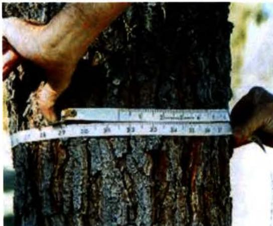
Figura 17. Posición correcta de la cinta diamétrica para medición del DAP.
