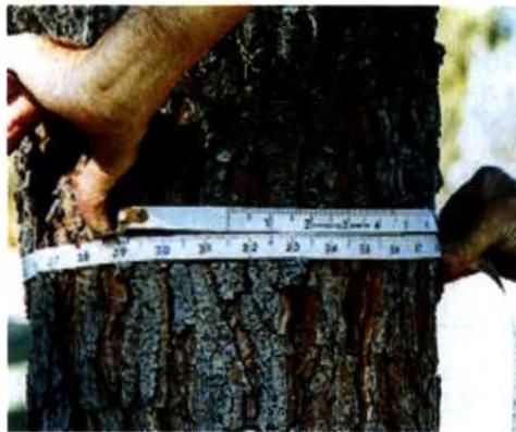
**Figura A: Posición correcta de la cinta diamétrica para medición del DAP.**
