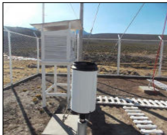
Fotografía N° 47 Estación Vilacota, registrador de lluvia Tipo balancín
