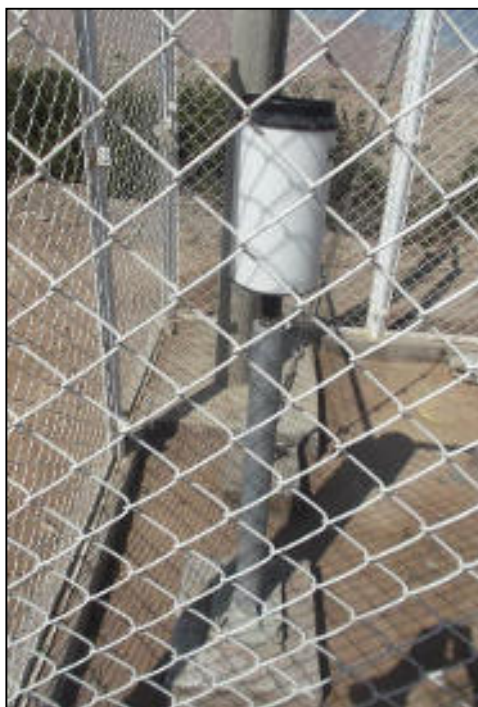
Fotografía N° 53 Estación Piedra Blanca, publimetro tipo balancin
