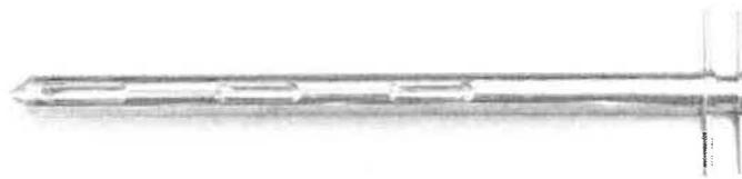
*Extractor de muestras - Corte transversal de la columna de lodo o biosólido*
